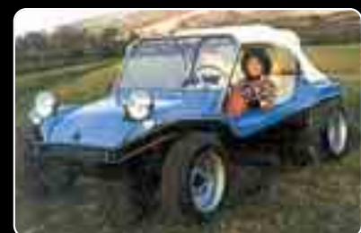
Μπάγκι: με σκελετό και μηχανικά μέρη του Φολκσβάγκεν 1200 κ.ε. και αμάξωμα από πολυεστέρα
